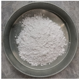
图 2 偏高岭土样本 Fig.2 Metakaolin powder
